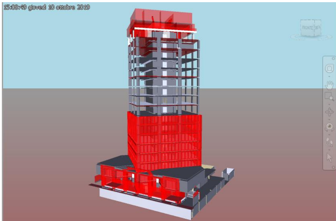
Figura 72: Simulazione 4D – Elevazioni muri P17,P18 e montaggio facciata continua P4,P5,P6 (Navisworks)
