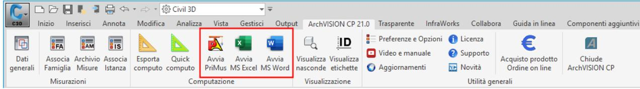
Associazione di **una o più** voci di EP da **qualsiasi listino** di PriMus tramite **"Drag & Drop"** direttamente in Civil 3D con **misurazioni configurate** su Famiglie (Entità dello stesso tipo e appartenenti alla stessa rete) o singole Istanze (Singole Entità), potendo redigere il computo direttamente in PriMus con **aggiornamenti successivi dinamici**, utilizzabile eventualmente anche in team (**lavori in Worksharing su progetti DWG, listini, misurazioni e computi DCF condivisi**)
